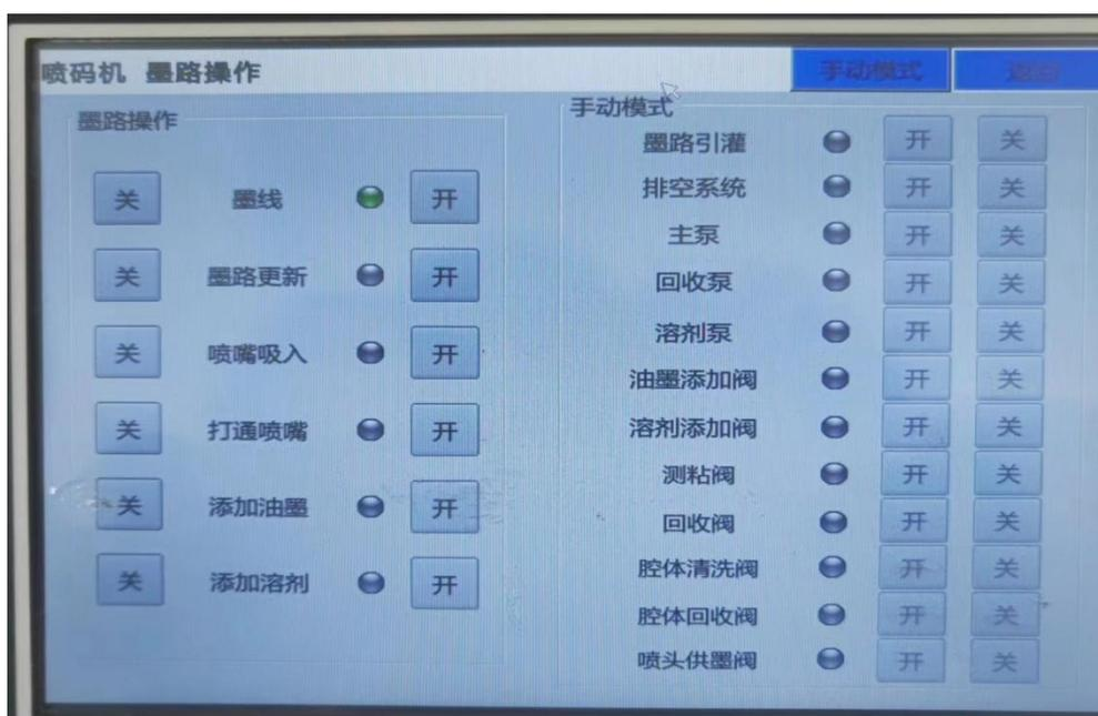
进入手动模式可检查电磁阀是否正常开启，主泵，回收泵，溶剂泵运转是否正常。
